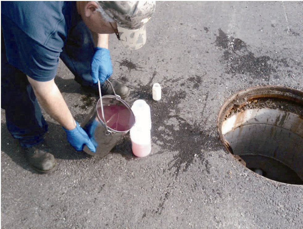
スラリー槽の汚水を収集するミルウォーキー都市下水道局サンプリング担当者
