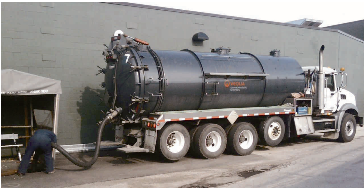
スラリー槽からの汲み上げを行うヴェオリア・エンバイロメンタル・サービス
